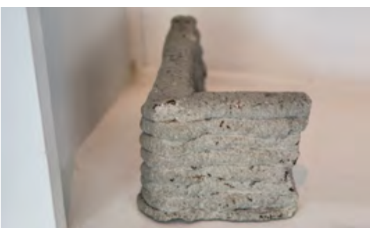
3D-print af et stykke cementvæg
